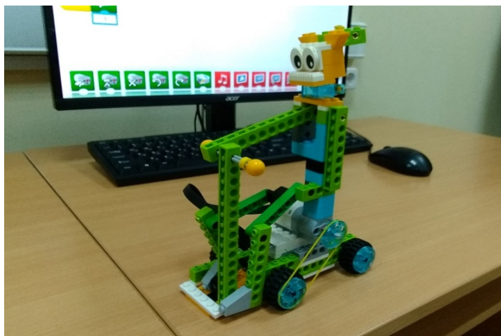
Рисунок 3. Заяц на велосипеде с ременной передачей Figure 3. Hare on a bike with a belt drive
